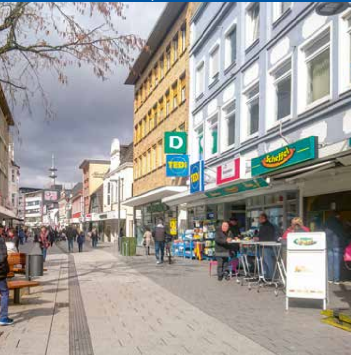
▲ Zonierter Straßenraum mit taktilen Mittelstreifen um auch sehbehinderten Mitbürgern die Orientierung zu erleichtern
