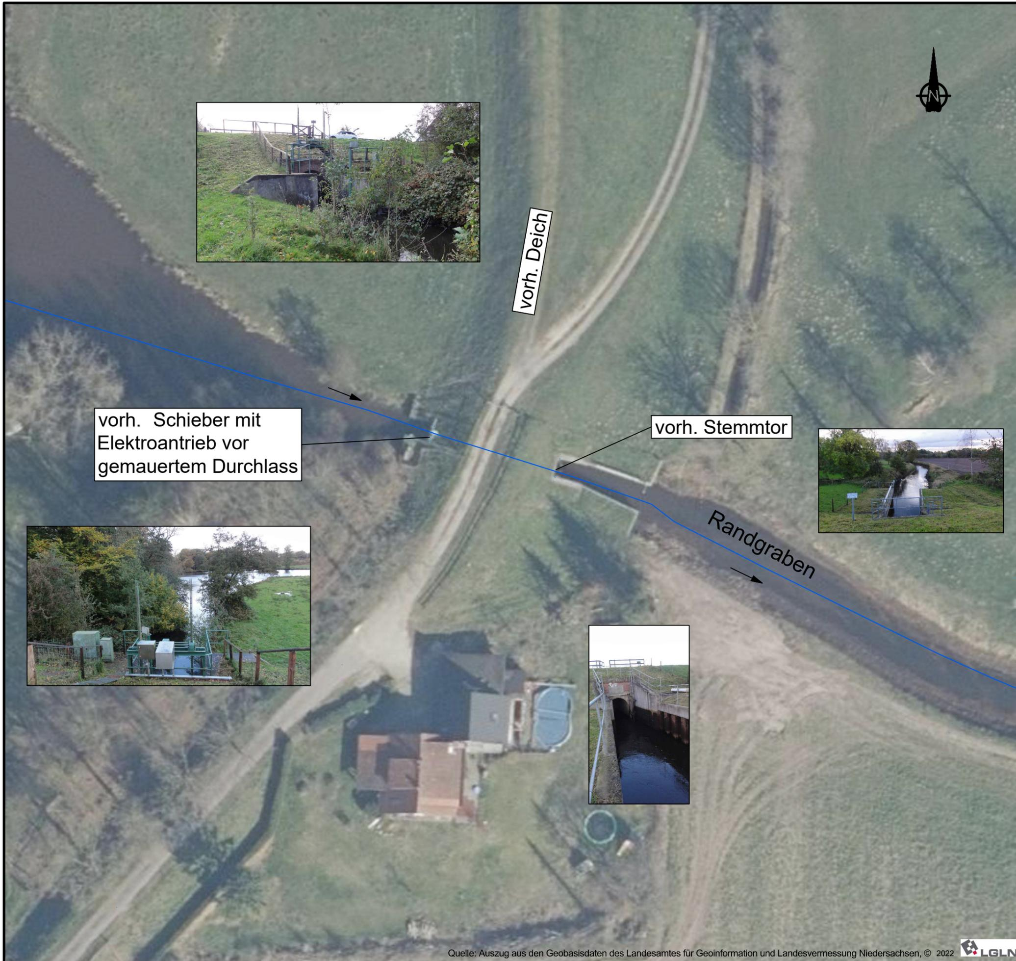
vorh. Schieber mit Elektroantrieb vor gemauertem Durchlass
