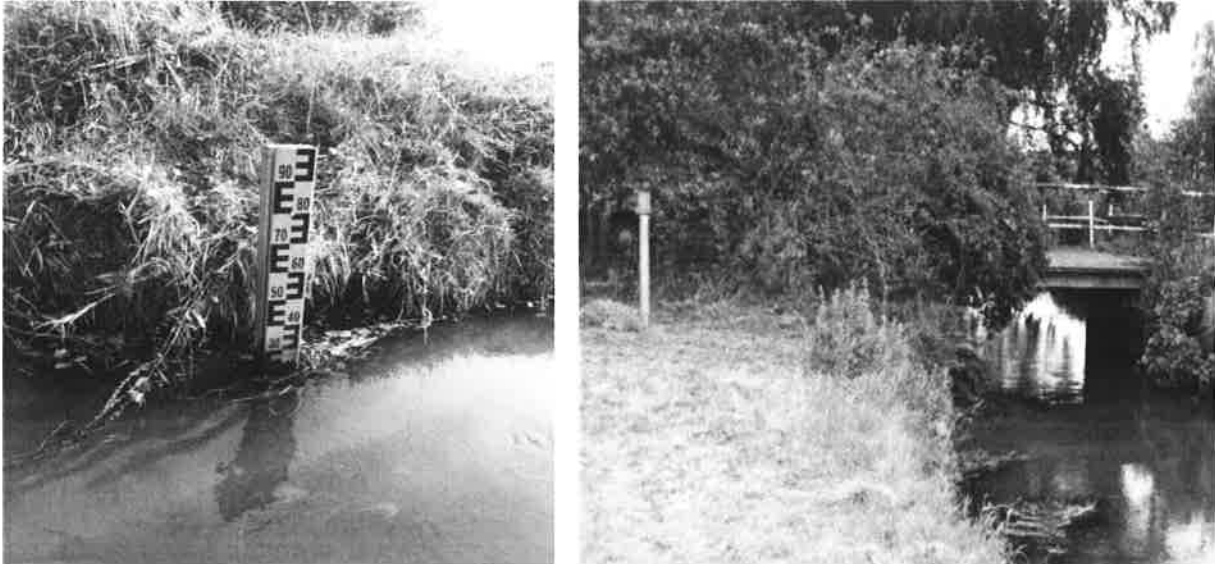
Abbildung 2: Aufbau des Pegels „DB1 (Dünsener Bach)“ mit Pegellatte und abgesetzter Pegelmesseinrichtung
